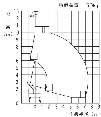
※作業範囲は、風速16m/s以下として計算したものとする。
