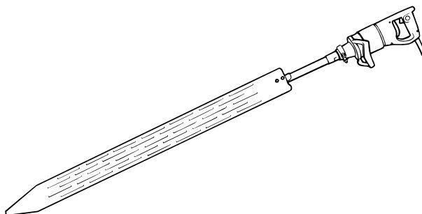
■モーター直結の強力な振動を振動板に伝達し、気泡の抜けにくい法面部の脱泡や表面仕上げに効果があります。
