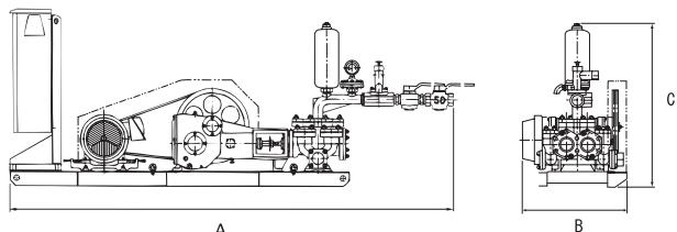
■高圧グラウト用として、また試錐あるいは高揚程揚水用ポンプとして広範囲にご利用いただけます。また、小型軽量で移動、運搬に便利であり、取扱いが簡単で、その性能と耐久性は作業効率の大幅アップをもたらします。
