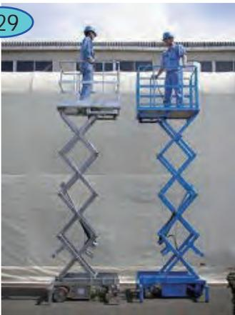
手押しで移動するタイプです。作業床高さ 3.8m。バッテリー式の油圧パッケージでスムーズな昇降。工場内の天井クレーンでの移動も可能。(専用フック付)
